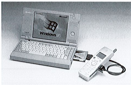
図2. IPC0004A の使用例 PC のカードスロットに装着され、付属のケーブルで PHS 移動機と接続する。
