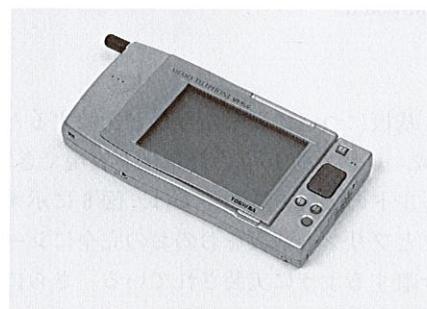
図 1. メモ電話機 MT-10JC 携帯性を重視したサイズになっている。 MT-10JC memotelephone
