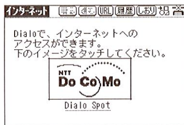
図 3. WWW ブラウザ HTML 2.0 準拠で、白黒 2 値ながら画像の表示も可能である。WWW browser
