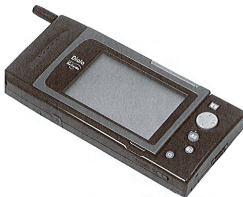
図 1. 携帯電話一体型情報端末 “Dialo” 270 cc, 240 g のコンパクトなボディに、携帯電話と電子手帳機能を備えた携帯情報端末である。Dialo PDC-integrated personal digital assistant
