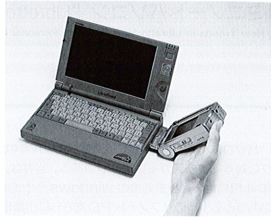
図1. “Libretto100”とデジタルスチルカメラ“Allegretto50”の接続例 カメラを“Libretto100”のPCカードスロットに接続して使用する。
