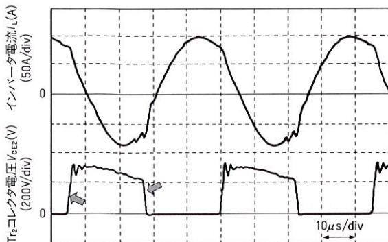
図4. インバータ電流 ( I_L ) 波形と Tr_2 コレクタ電圧 ( V_{CE2} ) 波形 3kW加熱時のインバータ波形を示す。
