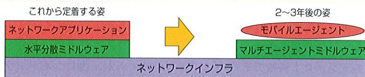
図4. ネットワークソフトウェアアーキテクチャの現状と今後 ネットワーク社会に向けたソフトウェア技術は水平分散ソフトウェアアーキテクチャから、2~3年後にはモバイルエージェントアーキテクチャに移行していく。 Trend in network software architecture
