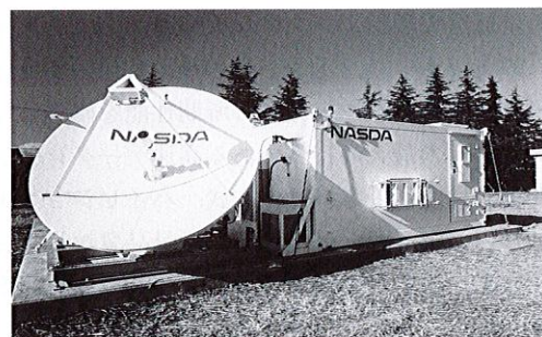
図4. 可搬型送受信局 アンテナとシェルタの外観を示す。Experiment station
