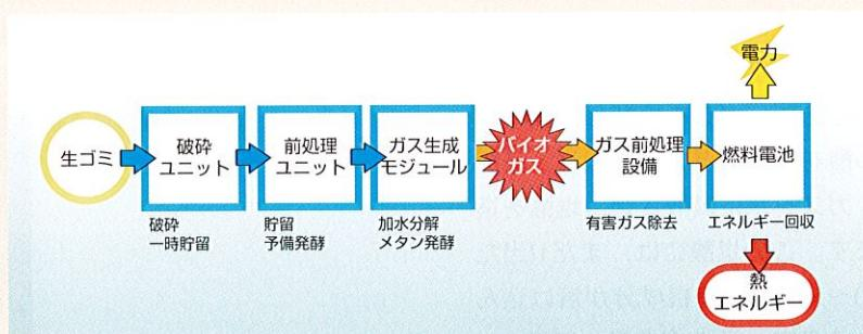
図3. 生ごみバイオガス化発電システムの処理の流れ
