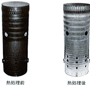
図5. 燃焼器ライナの組織回復例 開発した熱処理法によって処理した例で、延命化と信頼性改善が図れた。
