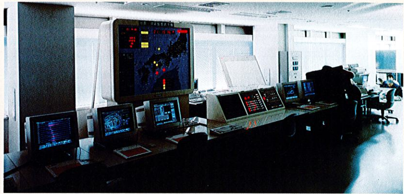
図3. 地震・津波監視表示板 地震や検潮の状態が規模ごとに異なった色でランプ点灯され、地震の発生状況を集約表示し、地震記録の自動読取りや震源計算結果を表示するグラフィックディスプレイと併せて地震活動を24時間監視する。 Earthquake and tsunami observation system
