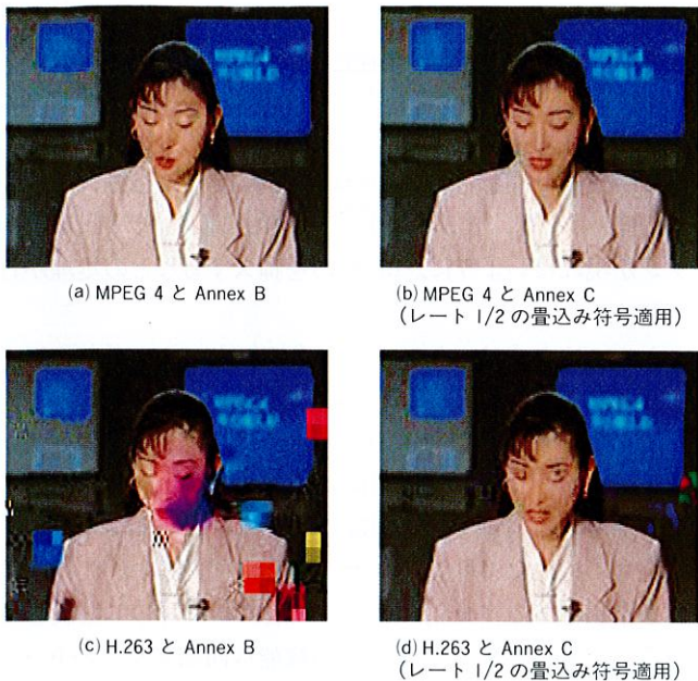
図 6. 各映像符号化方式と各 H.223 Annex 多重化方式を組み合わせる場合の画質比較 PHS の誤りパターンにおいて、MPEG 4 映像符号化方式では、ヘッダ内の多重化パターンが H.223 Annex B 方式で保護されれば、十分な画質が得られている。
