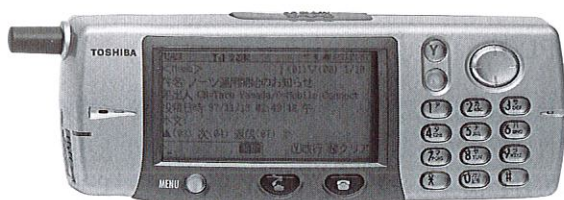
図 7. PHS メールウォーカー“読める電話機” MC-01 電子メールや電話帳を表示する大型液晶画面と、それを操作するマルチファンクションキー、10 キーで構成される。
