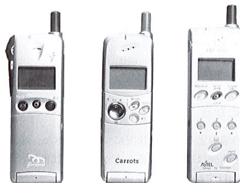
図 12. PHS 端末シリーズ PHS の特長を生かして FM ラジオ付きなどバリエーション機種の展開を図っている。
