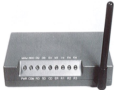
図 18. 据置き型 PHS アダプタ TPAD1000 自動販売機の上に設置され、自動販売機が送ってくるさまざまな情報を RS232C を通じて取り込みボトラーのセンターへ伝送する。
