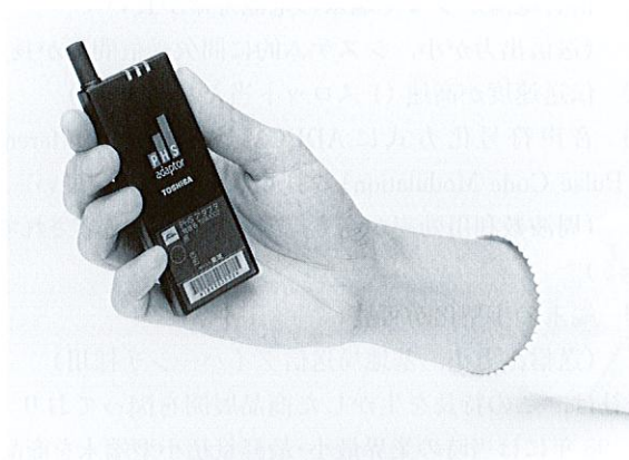
図15. PHSアダプタTPA1002 部品として使用されるため、厚さ9mmの長方形になっている。
