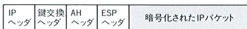
図2. IPセキュリティのパケット形式 暗号化されたIPパケットに鍵交換のためのヘッダとAHヘッダおよびESPヘッダが付加される。 IP-security packet format
