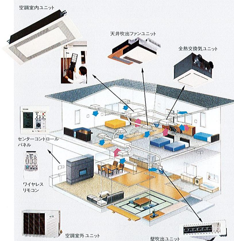
空気制御システムイメージ図（戸建）
