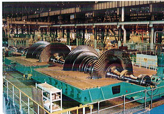
北侖港向け TC4F-42 インチ、600 MW 蒸気タービンの工場組立風景 TC4F-42inch 600 MW turbine assembly at Keihin Works
