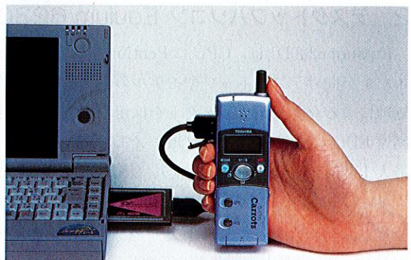
PHS 電話機に接続し、PC に装着中の PHS データコミュニケーションカード PHS data communication card installed in PC and connected to personal handy-phone
