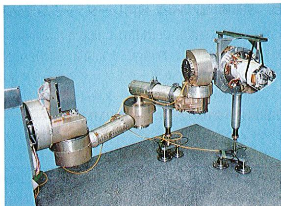
ETS-VIIロボットアーム動的閉ループ試験
