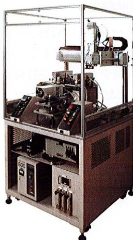
試作した鉛フリーはんだ付け装置
