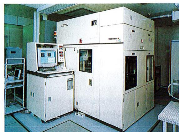
マスク欠陥検査装置 MC-2000
