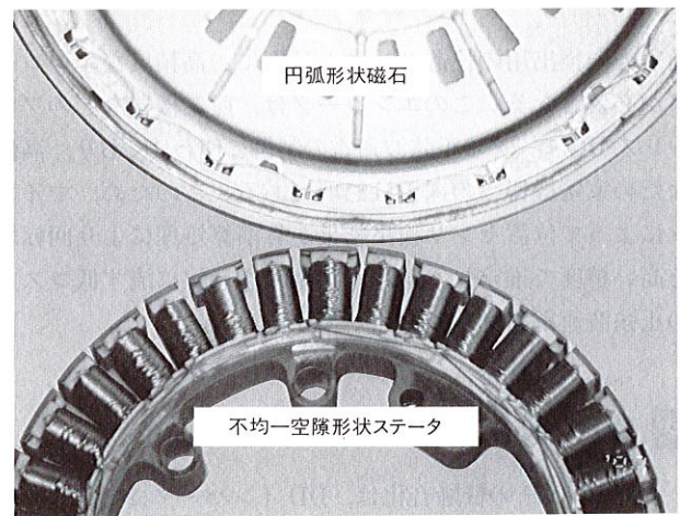
図4. コギング音低減の構造 マグネットの円弧形状化、ステータの不均一空隙化によりコギングトルクを低減した。
