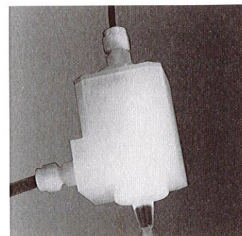
図5. 薬液対応メガヘルツノズル 単結晶サファイアを振動板にした薬液対応メガヘルツノズルにより、枚葉装置でも薬液中での極超音波照射が可能となった。
