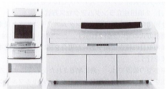
図1. 自動分析装置 TBA-200FR 装置は分析部およびコンソール部から構成されている。
