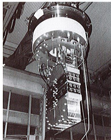
図 3. 試作要素コイル通電試験装置 試験のためにフランジに取り付けた状態のコイルを示す。
