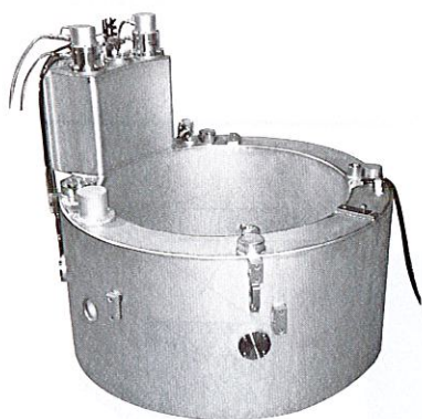
図4. 単結晶引き上げ装置に使用される冷凍機直冷式超電導磁石 直冷方式により、超電導磁石の小型化、操作性の簡便化が実現した。 Conductive-cooled superconducting magnet for silicon single-crystal fabrication
