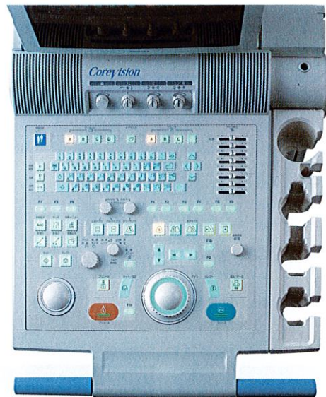
図 7. 操作パネル 右トラックボールを中心に使用頻度の高いスイッチを周辺に配置したパームコントローラを採用した。
