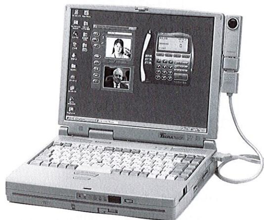
図1. ポータブルPC Tecra750 デスクトップPCに匹敵する機能を持ち、カラービデオカメラによりビデオ電話を行うことができる。
