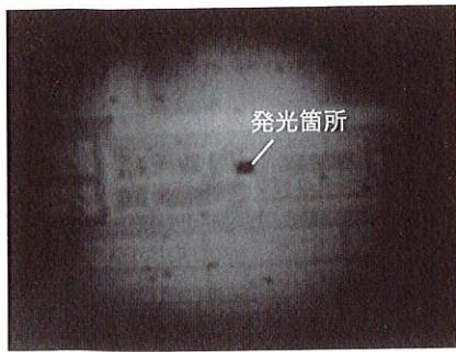
図 4. 裏面からのエミッショントレンチキャパシタの顕微鏡写真 近赤外領域に感度をもつエミッショントレンチキャパシタで観察することにより、チップ裏面から発光箇所の特定が可能となった。
