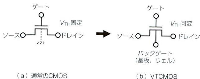
図7. VTCMOSでのトランジスタの用いかた VTCMOSでは、通常は電源に接続されている“バックゲート”を“第四の端子”として取り出すことにより、 $V_{TH}$ を可変にした。
