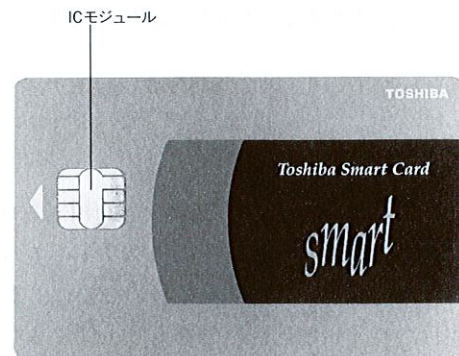
図1. IC カードの外観 塩化ビニルシートに、接点付き IC モジュールが埋め込まれている。
