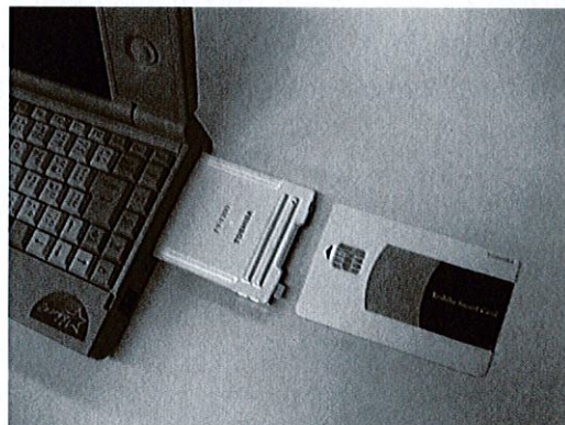
図1. IC カードリーダライタ ポータブル PC に適した PC カードタイプの IC カードリーダライタ (FY1300)。
