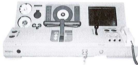
図1. 運転台コンソール 運転士の業務を支援する表示器、マスクコントローラなどを運転台コンソールに集約している。 Cab console (display and master controller)
