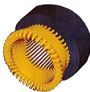
図6. 固定子コイルエンド解析モデル 固定子コイルエンド部の三次元CAE解析モデルを自動生成した結果である。黄色がコイルでブルーが鉄心である。Stator coil end calculation model
