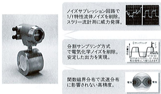
図1. グローバル対応電磁流量計 SuperMAG TM シリーズ 最新の信号処理技術、磁気設計技術が電磁流量計に集約され高精度、高安定性を実現している。
