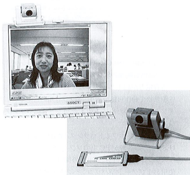
図2. IK-D30の外観 上図はパソコン装着状態であり、下図に卓上設置状態を示す。
