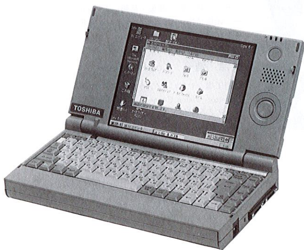
図 1. Libretto のリブポイント 立ち作業での操作に適した位置に設けられ、片手で操作できるモバイル PC Libretto のポインティングデバイス リブポイント。
