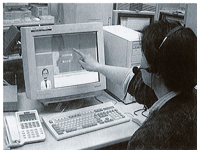
図5. マルチモーダル 秘書エージェント 音声入力とタッチ入力を同時に行い、それらを統合した解釈をすることができる。
