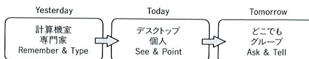
図1. HI の進化 コマンド言語入力方式の第一世代から GUI 方式の第二世代、そしてマルチモーダル インタフェースの第三世代の HI へと進化していく。
