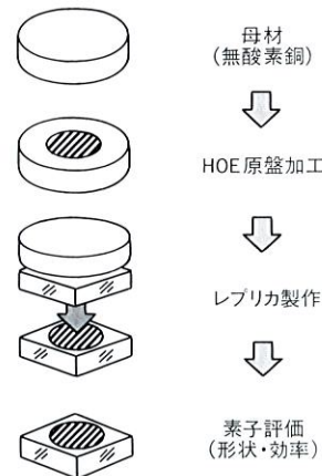
図4. HOEの製造プロセス マスタとなる原盤の加工精度とレプリカへの転写性が重要である。 HOE fabrication process
