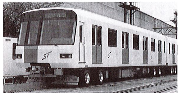
図1. 札幌市営地下鉄5000形電車 ゴムタイヤ式の6両固定編成である。
