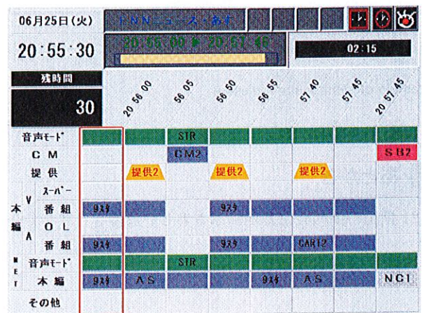
図5. オンエアスケジュール監視画面 従来の文字情報からグラフィカルな画面となりわかりやすくなった。
