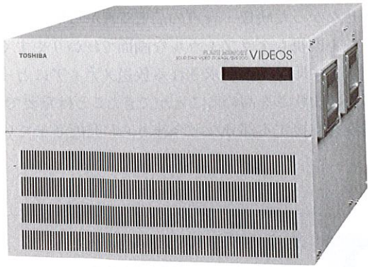
図3. フラッシュ VIDEOS™ 放送品質の映像と音声リアルタイムに記録再生できる不揮発性の半導体ファイルシステム。 Flash VIDEOS™
