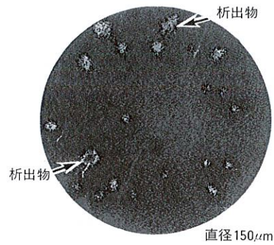
図 9. 熱処理 Si ウェーハ内部の酸素二次イオン像 直径 150 μm の酸素二次イオン像で、SiO 2 析出物に相当する高濃度酸素領域が点在している。
