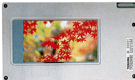
図 1. 対角 13 cm (5 型) TFT-LCD モジュール TFD50W60 16:9 の画面に 853×480 の画素をストライプ配列し、高精細な表示を実現した。
