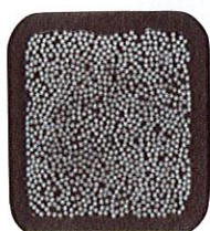
図2. 強制冷却導体 この導体で、数万 A の電流を流すことが可能。ステンレス管が強大な電磁力を支えるので、直径 10m を超える大型コイルに適している。
