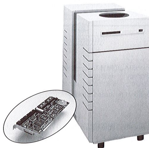
図1. 階層ストレージシステム MicroHSM TM PCI シングルボードのコントローラで高性能の階層ストレージ制御機構を実現した。 MicroHSM TM hierarchical storage management system
