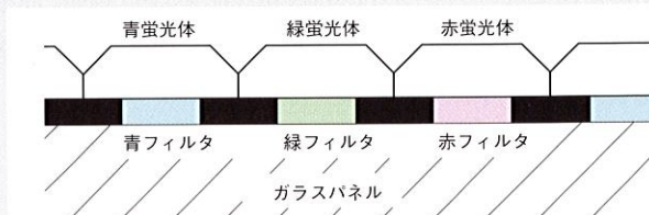
マイクロフィルター TM 蛍光面構造 Screen structure of MICROFILTER TM
