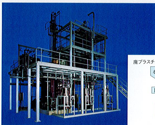
廃棄プラスチック油化処理装置 System for oil reclamation from resin wastes
