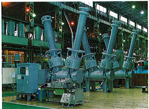
複合碍管ブッシングを適用した 300 kV ガス遮断器 300 kV gas circuit breaker with composite insulator bushings
