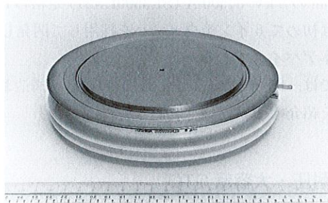
図5. 6 インチサイズ GTO の素子外観 電極直径 130 mm、最大外形寸法 190 mm \phi の 6 インチ GTO 外観を示す。
