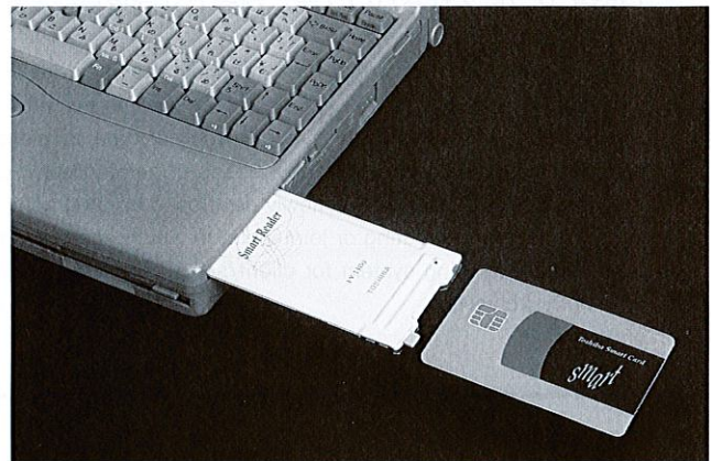
図3. ICカードリーダライタ ポータブルPCに適したPCMCIAタイプのICカードリーダライタ(FY-1300)。Smart card reader/writer
