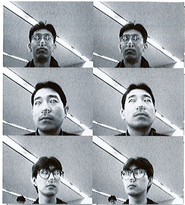
図 8. 抽出された瞳と鼻孔 “+” が各特徴点の位置を示している。 Extraction of pupils and nostrils
