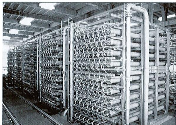
図2. 逆浸透膜ユニット 逆浸透膜に圧力をかけた海水を通すことにより、真水を取り出すことができる。
